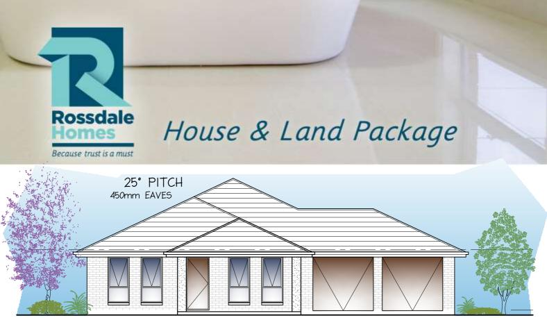
FRONT ELEVATION - TO BE FACE BRICK - RENDERED BRICK PIERS TO PORTICO
